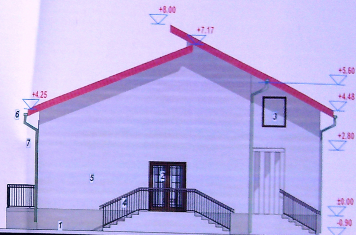
Fatada principala(de est) finisaje:1-soclu impermeabil; 2-usa metalica de acces principal; 3-fereastră PVC nuanta lemn; 4-balustrada metalica;5-tencuiala decorativa alba;6-igheab; 7-burlan
